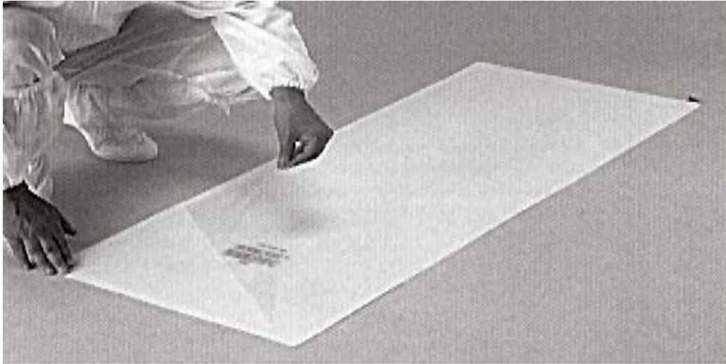
Sticky-Mat-Klebefolienmatten sind auf der Ober- und Unterseite mit einer sehr dünnen Schutzfolie versehen, die vor Gebrauch jeweils entfernt werden müssen. Zuerst wird die Unterseite abgezogen und die Matte an die dafür vorgesehene Stelle angebracht. Anschließend zieht man die dünne Schutzfolie auf der Oberseite ab. Nun kann die Matte in Betrieb genommen werden.
